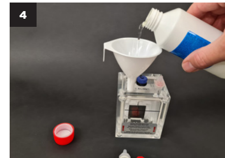
Führen Sie den Trichter in die erste Kammer ein und gießen Sie Natriumchlorit bis zur Markierung auf dem Generator.
