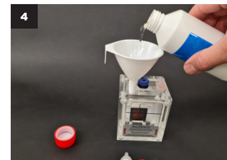
Insérez l'entonnoir dans l'orifice de la première chambre et versez le chlorite de sodium jusqu'au repère placé sur la paroi du générateur.
