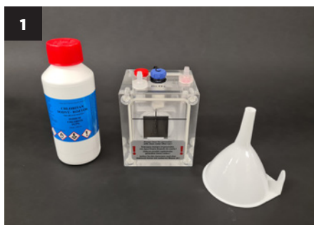
Připravte si generátor, trychtýř a chloritan sodný-roztok.
