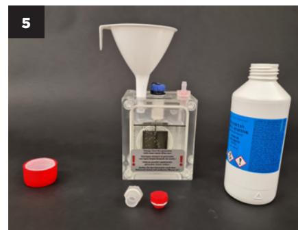
Relleno hasta la línea, correcto.
